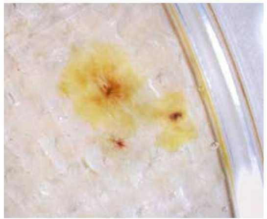
Oben pfui und unten hui: Bei einem Teil der Proben entwickelt sich eine bedenkliche Anzahl an Keimkolonien. Die mit den DeCont-Spiralen versetzten blieben unkritisch.
